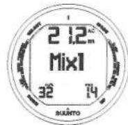
Рис. 6.19 Смена дыхательной смеси. Текущая смесь MIX1 (32%). Переход между подключенными смесями осуществляется нажатием UP/DOWN. Подтвердите выбор смеси, нажав кнопку S.
