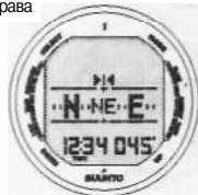
Рис. 4.2. Нажатием кнопки (S) можно задать направление, 45 градусов на северо-восток
