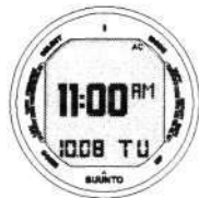
Рис.2.3. Водоактивируемые контакты в активном режиме отображают текст AC
