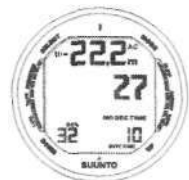
Рис. 6.16 Погружение в режиме Nitrox. Установленное O 2 % - 32%.
