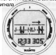
Рис. 4.1 Дисплей компаса (из режима TIME). Направление - северо-запад. 305 градусов. Заданный курс справа
