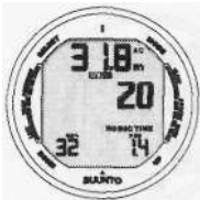
Рис. 6.17. Дисплей PO2 Парциальное давление кислорода 1.4 бар
