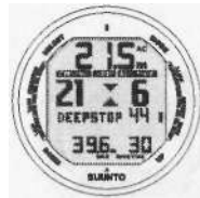
Рис. 6.9 Глубокая остановка. Вам рекомендуется сделать глубокую остановку на 21 м. Второй индикатор показывает, что Вам осталось 44 секунды для данной глубиной остановки.
