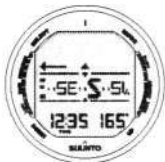
Рис. 4.3. Треугольник показывает, что Вы отклоняетесь от заданного курса на 120 градусов.
