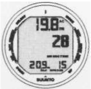
Рис. 6.2. Дисплей во время погружения. Глубина 19.8 м, предел бездекомпрессионного погружения 28 минут. Максимальная глубина для данного погружения составляет 20.9 м, время погружения 15 минут.
