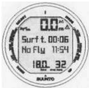
Рис. 6.24. Дисплей на поверхности. Со времени подъема на поверхность прошло 6 минут после 32-минутного погружения с максимальной глубиной 18 м. Текущая глубина 0.0 м. Символ самолета и значение No-Fly показывают, что Вы не должны пользоваться авиатранспортом 11 ч 54 мин. Символ предупреждения водолаза показывает, что Вам следует продлить время пребывания на поверхности из-за большого количества микропузырьков в крови.
