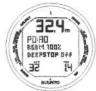
Рис 6.15. Активация режима Nitrox Dive. Максимальная глубина зависит от установленных O 2 % (32%) и PO 2 (1.4 бар) и составляет 32.4 м.
