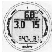
Рис. 6.11. Погружение с декомпрессионными выдержками, водолаз выше пола декомпрессионной остановки. Указывающая вверх стрелка исчезла, индикатор ASC TIME перестал мигать, что означает, что Вы достигли зоны декомпрессии
