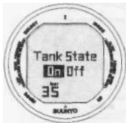
Рис. 5.24 Беспроводная передача данных выключена (off), для активации нажмите up/down. Сигнал тревоги установлен на давление 35 бар.
