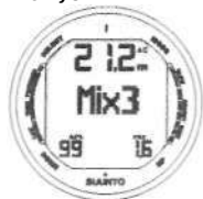
Рис. 6.20 Смена дыхательной смеси. Максимальная глубина превышена, выбор данной смеси осуществить невозможно. Величина PO_2 мигает.
