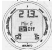
Рис. 5.14. Установка дополнительных ДГС (MIX2, MIX3).
