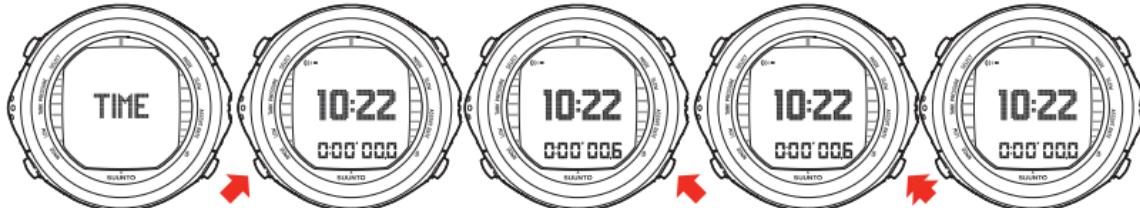
ВОСПОЛЬЗУЙТЕСЬ КНОПКОЙ DOWN ДЛЯ ЗАПУСКА СЕКУНДОМЕРА И ИЗМЕРЕНИЯ ВРЕМЕНИ НАРАСТАЮЩИМ РЕЗУЛЬТАТОМ. КНОПКА UP ОСТАНАВЛИВАЕТ СЕКУНДОМЕР, А ПРОДОЛЖЕЛЬНОЕ НАЖАТИЕ СБРАСЫВАЕТ ЕГО ПОКАЗАНИЯ.
