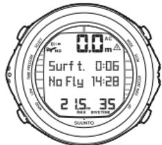
ВЫ НАХОДИТЕСЬ НА ПОВЕРХНОСТИ 6 МИНУТ ПОСЛЕ 35-МИНУТНОГО ПОГРУЖЕНИЯ. МАКСИМАЛЬНАЯ ГЛУБИНА СОСТАВИЛА 21,5 М. ТЕКУЩАЯ ГЛУБИНА РАВНА 0,0 М. СИМВОЛ САМОЛЕТА И ЗНАЧЕНИЕ ПАРАМЕТРА NO-FLY УКАЗЫВАЮТ НА ТО, ЧТО ВЫ НЕ ДОЛЖНЫ СОВЕРШАТЬ АВИАПЕРЕЛЕТЫ В ТЕЧЕНИЕ 14 ЧАСОВ И 28 МИНУТ. СИМВОЛ DIVER ATTENTION УКАЗЫВАЕТ НА ТО, ЧТО ВЫ ДОЛЖНЫ УВЕЛИЧИТЬ ПРОДОЛЖИТЕЛЬНОСТЬ ВАШЕГО ПЕРЕРЫВА НА ПОВЕРХНОСТИ.
