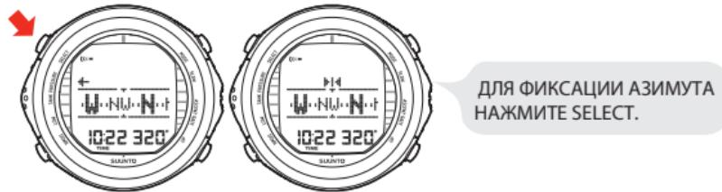
Подводный компьютер Suunto D9tx также помогает при навигации по квадратным и треугольным маршрутам, а также при навигации обратным курсом. Для этого применяются следующие графические символы, расположенные в центре дисплея компаса:
