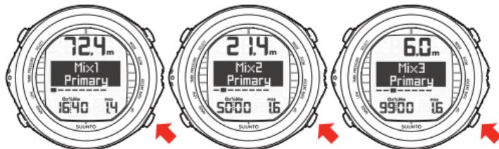
В режиме настройки параметров режима MIXED будет также отображаться эквивалентная максимальная рабочая глубина, определенная по выбранным параметрам.
