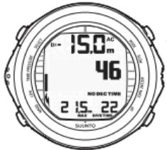
ДИСПЛЕЙ ПОГРУЖЕНИЯ - ТЕКУЩАЯ ГЛУБИНА 15 М, БЕЗДЕКОМПРЕССИОННЫЙ ПРЕДЕЛ ВРЕМЕНИ 46 МИН. МАКСИМАЛЬНАЯ ГЛУБИНА ПОГРУЖЕНИЯ СОСТАВЛЯЛА 21,5 М, С НАЧАЛА ПОГРУЖЕНИЯ ПРОШЛО 22 МИН.
