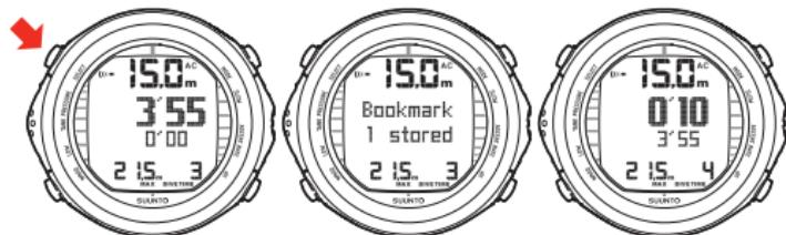
ПРИ НАЖАТИИ КНОПКИ SELECT ВО ВРЕМЯ ПОГРУЖЕНИЯ ПРОИСХОДИТ ЗАПИСЬ ЗАКЛАДКИ В ПАМЯТЬ ПРОФИЛЯ, СБРОС ВРЕМЕНИ ПОГРУЖЕНИЯ, И НИЖЕ ОТОБРАЖАЕТСЯ РАНЕЕ ИЗМЕРЕННЫЙ ИНТЕРВАЛ ВРЕМЕНИ.
